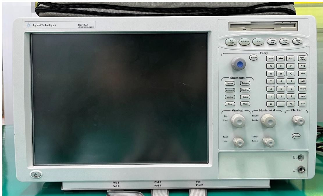
Logic Analyzer Agilent Technologies : 1681AD Chanel : 102 Time : 800MHz / 200MHz Voltage : -5V to 5V 1 unit
